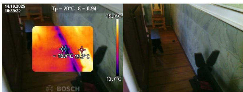
Overgang golv/ vegg bak altertavle. Tydelege temperaturavvik.
