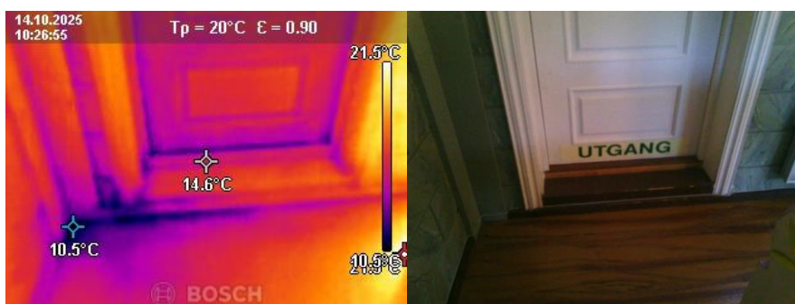
Bileta syner detalj ved utgang v/ altertavle. Kuldebru/ varmelekkasje i overgang golv/ vegg i hjørne, samt dårleg tetting mot dørrblad.
